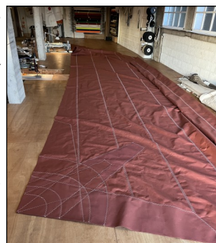
Pose des renforts
